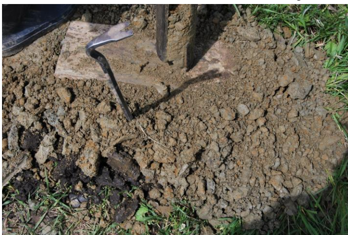
Foto 1: Intervalul aluvionar fin (argila nisipoasă, F7 (-1,50÷ -3,10m))
